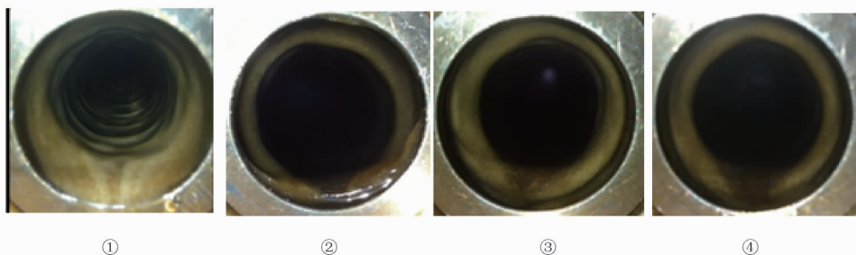
图 2 液速对沉积层截面分布的影响
