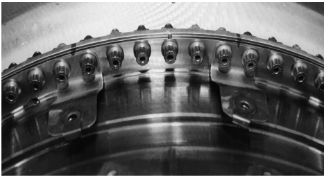
(a) 机匣法兰边螺栓连接
